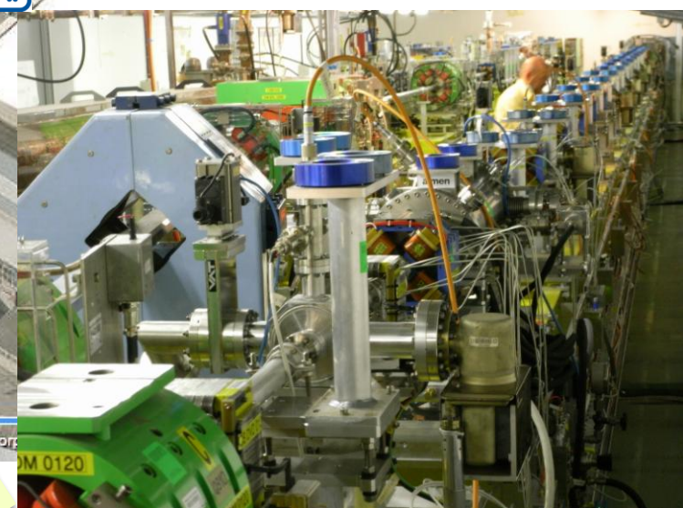
Bât 2010: Le CLEX vous permet de visiter un accélérateur d'essai destiné à l'étude de l'accélération à deux faisceaux. Bld 2010: The CLEX visit point allows visiting the accelerator test facility that studies the two-beam acceleration.
