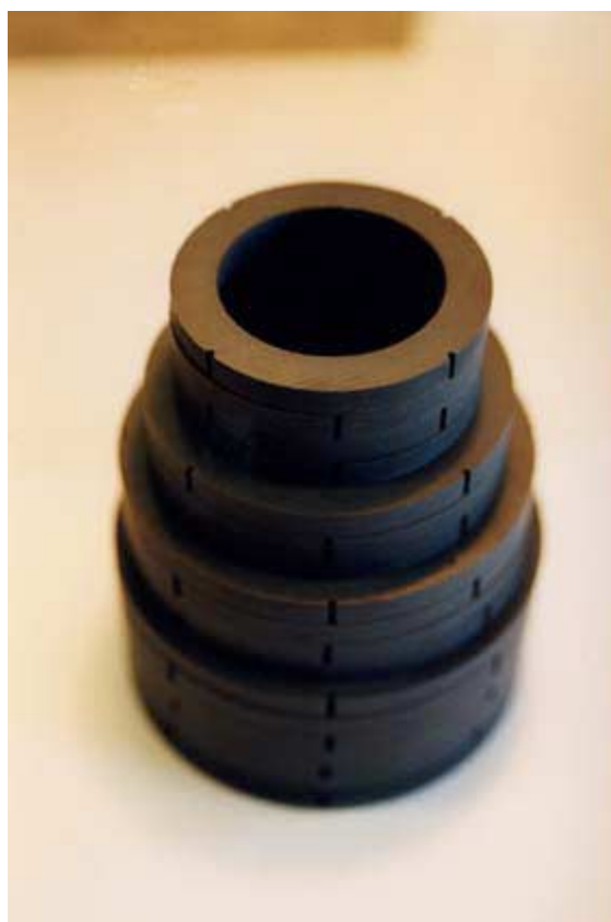
Fig. 5 Ferrites #61 jouant le rôle d'absorbeur hyperfréquence et d'inductance BF. Leur usinage est délicat (P. Favini/EST)
