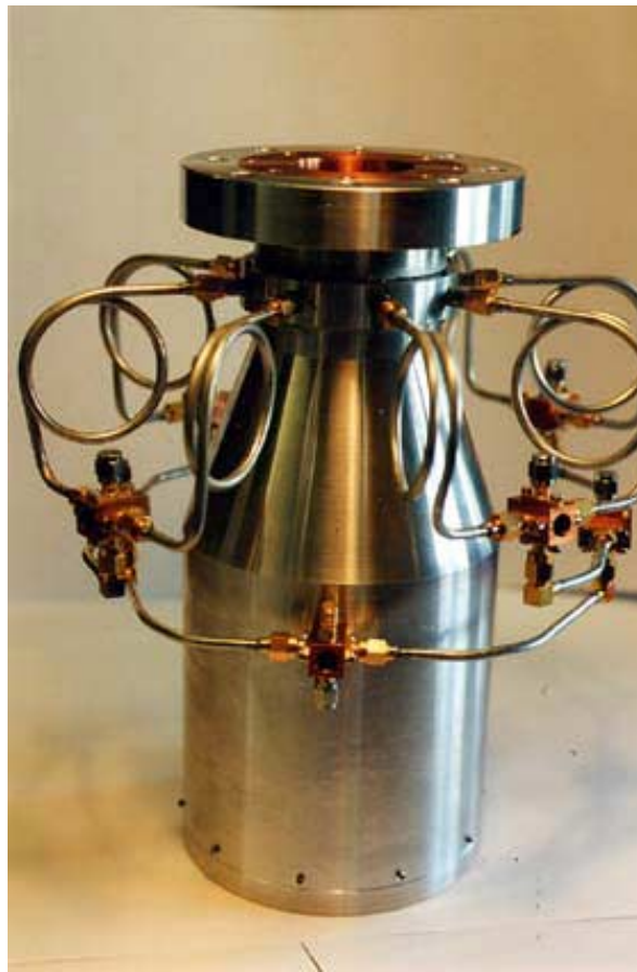
Fig. 3 Longueur hors tout du WCM CTF3 = 249mm brides UHV DN63CF + joint CU OFE
